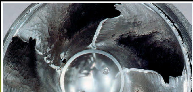
Oběžné kolo z duplexní korozivzdorné oceli
